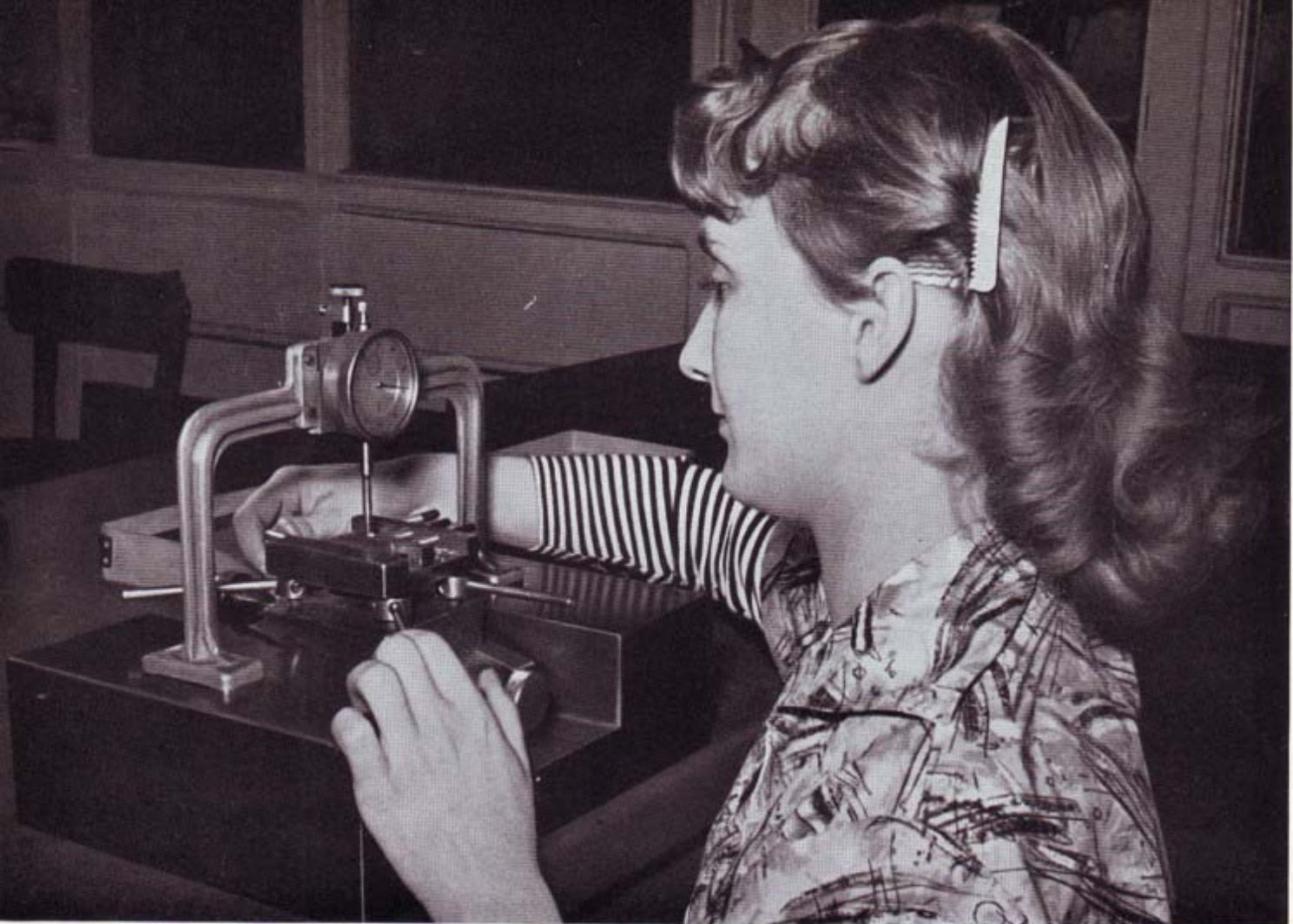
Antes de justificar se mide exactamente la profundidad del ojo de la matriz
